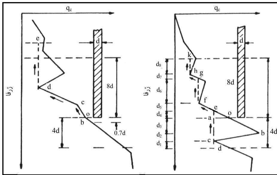
الف- مقاومت در زیر نوک شمع در ژرفای  $4d$       ب- مقاومت در زیر نوک شمع در ژرفای  $0.7d$
