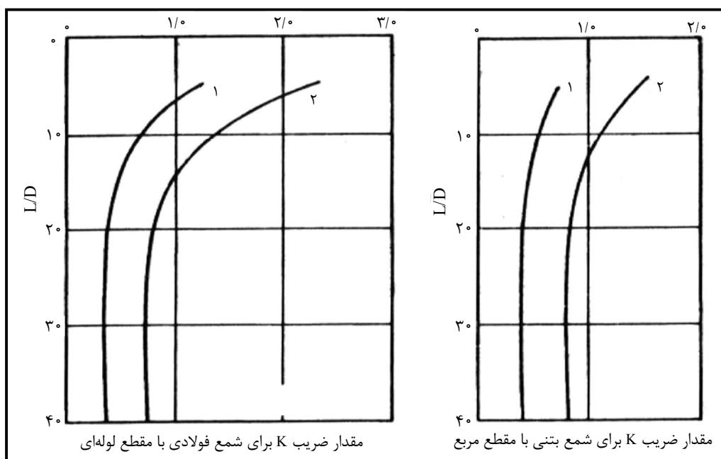
شکل ۱۶-۶- مقدار ضریب  $K$  برای شمع‌های فولادی و بتنی [۹ و ۳]
