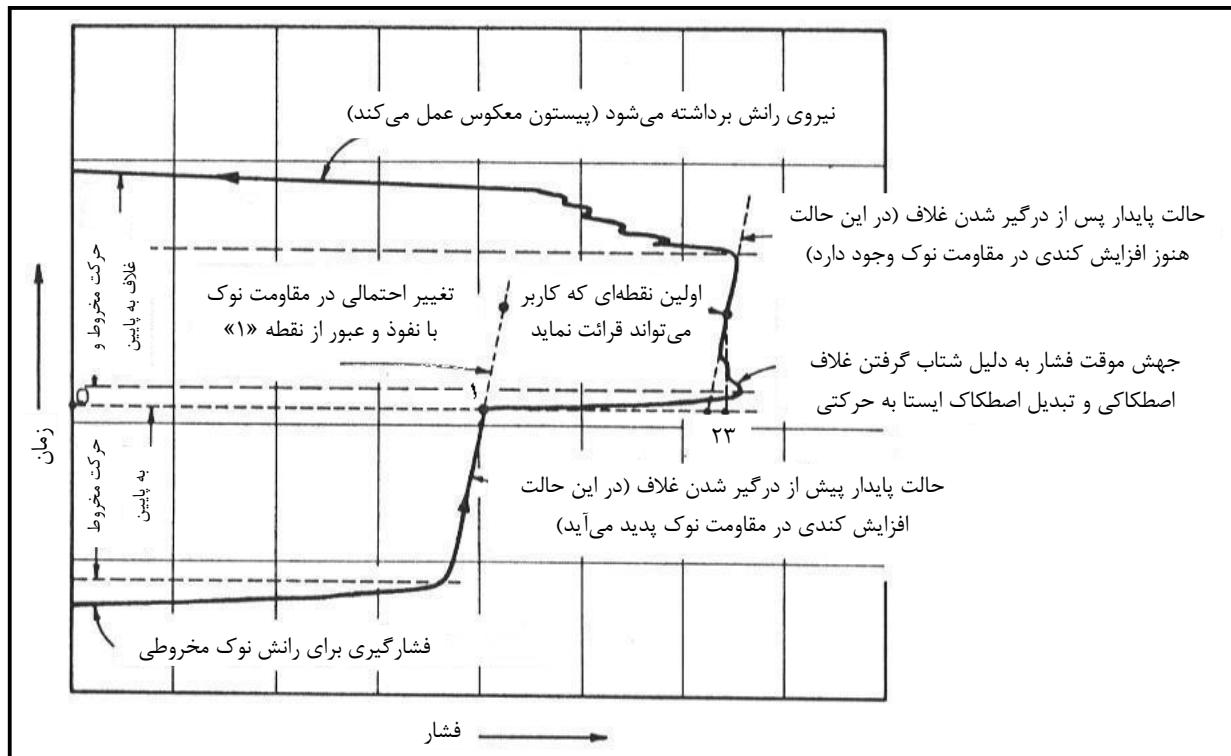
شکل ۴- نمودار تغییرات فشار در بارسنج هیدرولیکی در حین اندازه‌گیری نیرو در بالای میله‌های داخلی هنگام پیشروی نوک نفوذسنج مخروطی - اصطکاکی (مکانیکی) [۱]
