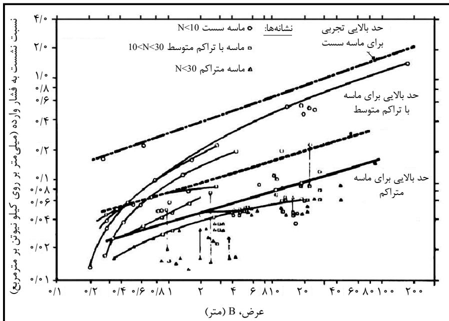
شکل ۱۲-۶- نشست مشاهده شده یا اندازه‌گیری شده پی‌های واقع بر روی ماسه با مقادیر مختلف تراکم نسبی [۲]
