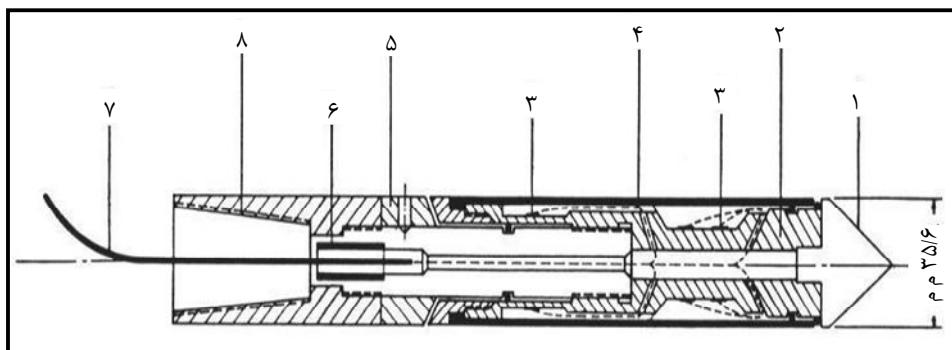
شکل ۳-۴- نوک نفوذسنجد مخروطی - اصطکاکی از نوع الکتریکی
