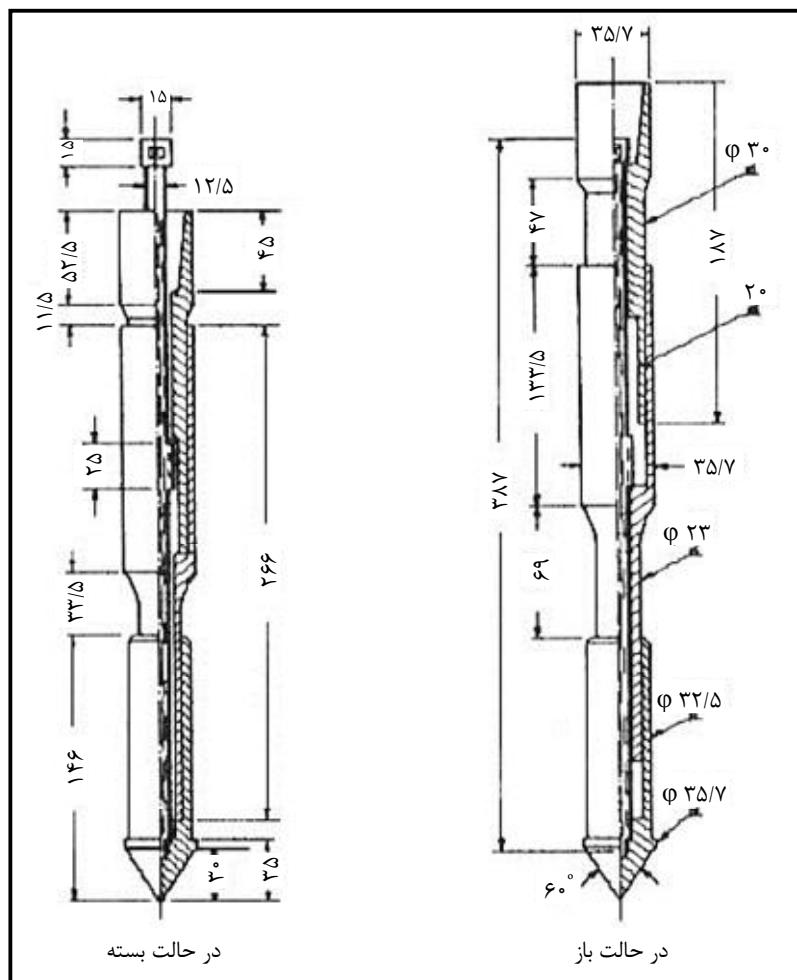
شکل ۳-۲- نمونه نوک یک نفوذ مخروطی - اصطکاکی مکانیکی (نفوذگر مخروطی - اصطکاکی بگمان<sup>۱</sup>) [۱]
